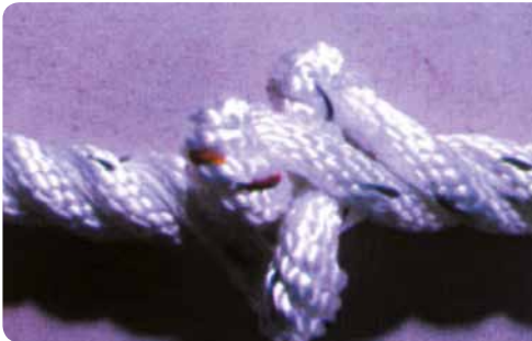
Abb. 4: Krankelbildung bei einem neuen Seil
