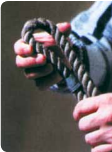
Abb 2: Prüfung der Schmiegsamkeit: Der Innendurchmesser muss etwa dem Seildurchmesser entsprechen (die Schlaufe muss ohne Kraftaufwand gebildet werden können)
