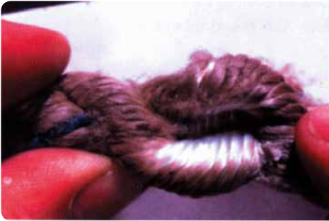
Abb 2: Prüfung der Schmiegsamkeit: Der Innendurchmesser muss etwa dem Seildurchmesser entsprechen (die Schlaufe muss ohne Kraftaufwand gebildet werden können)
