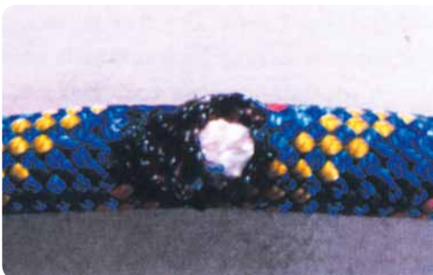
Abb. 13: Anschmelzstelle bei einem Kern- Mantel-Seil
