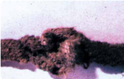
Abb. 5: Krankelbildung bei einem alten, verschmutzten Seil
