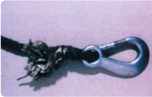
Abb. 8: Gelockerter Spleiß und fehlende Karabinersicherung
