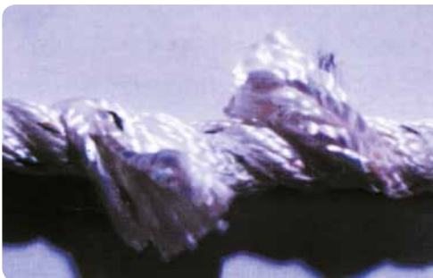
Abb. 6: Faserrisse bei einem gedrehten Seil
